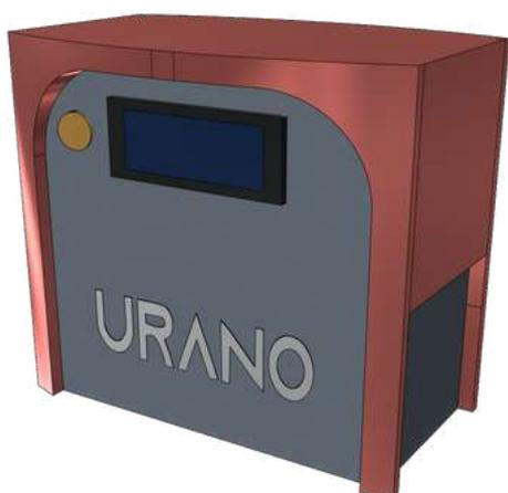
URANO è il un dispositivo elettronico grazie al quale è possibile rilevare l'ossigeno disciolto nel refluo e gestire l'ossigenazione all'interno dell'impianto qualora quest'ultimo valore scenda sotto una determinata soglia. Inoltre, URANO è in grado di attivare l'irrigazione automatica in base all'umidità del terreno.
